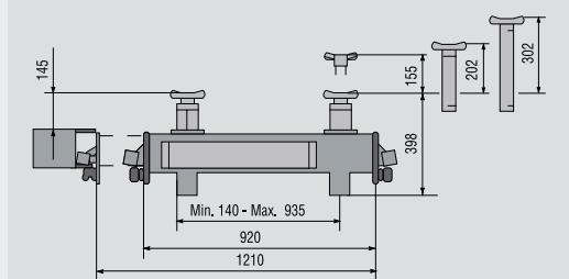
Traverse hydraulique/hydro-pneumatique à double piston
