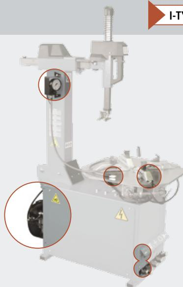
Versioni con dispositivo di gonfiaggio pneumatici tubeless incorporato. Il dispositivo è azionato da un unico comando a pedale a due posizioni.
